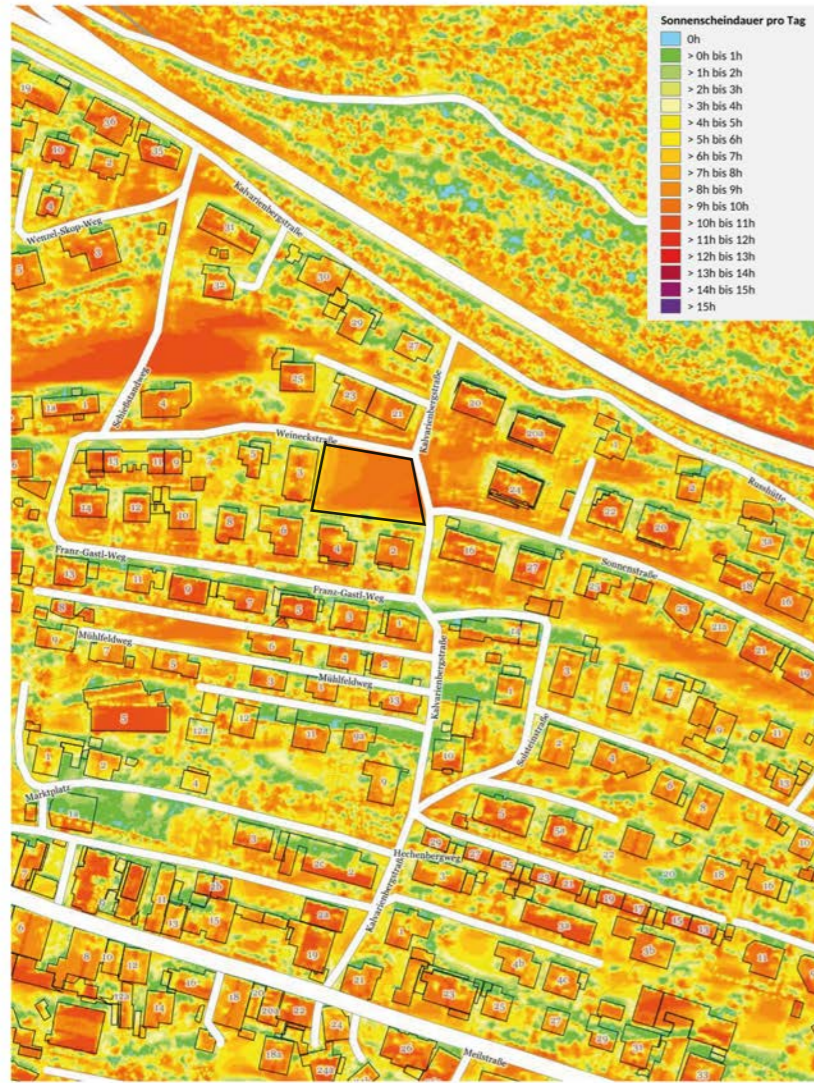
Solarpotenziale in Tirol - Datenstand 2013 Amt der Tiroler Landesregierung - Sg. Landesstatistik und TIRIS
