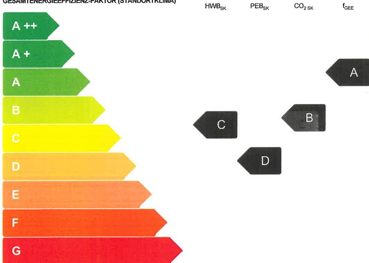
**HWB:** Der **Heizwärmebedarf** beschreibt jene Wärmemenge, welche den Räumen rechnerisch zur Beheizung zugeführt werden muss. Die Anforderung richtet sich an den wohngebäudeäquivalenten Heizwärmebedarf.
